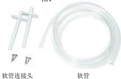
差压开关压力连接方式为两个 $\phi 6$ 形接头及外径 $\phi 7$ 软管连接和软管连接头(见图1)。正压端(高压)和低压端(真空)均分别标注" + "和" - "。为了获得最快的响应时间, 建议您在使用内径为 $\phi 5$ 软管的长度最好不要超过15米。
